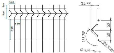
De acordo com o projeto padrão fornecido pelo FNDE (para terreno de 45 x 35 m), haverá fechamento com gradil de 1,58m de altura, com pilaretes metálicos e tela de aço galvanizado de tamanho fixo, instalado na parte frontal do lote, acima de mureta de alvenaria de 0,62m de altura. Caso o terreno disponível seja maior, o ente requerente poderá utilizar-se do padrão de fechamento aqui descrito para a instalação em todo o seu terreno, ficando o custeio do excedente a cargo do requerente.
